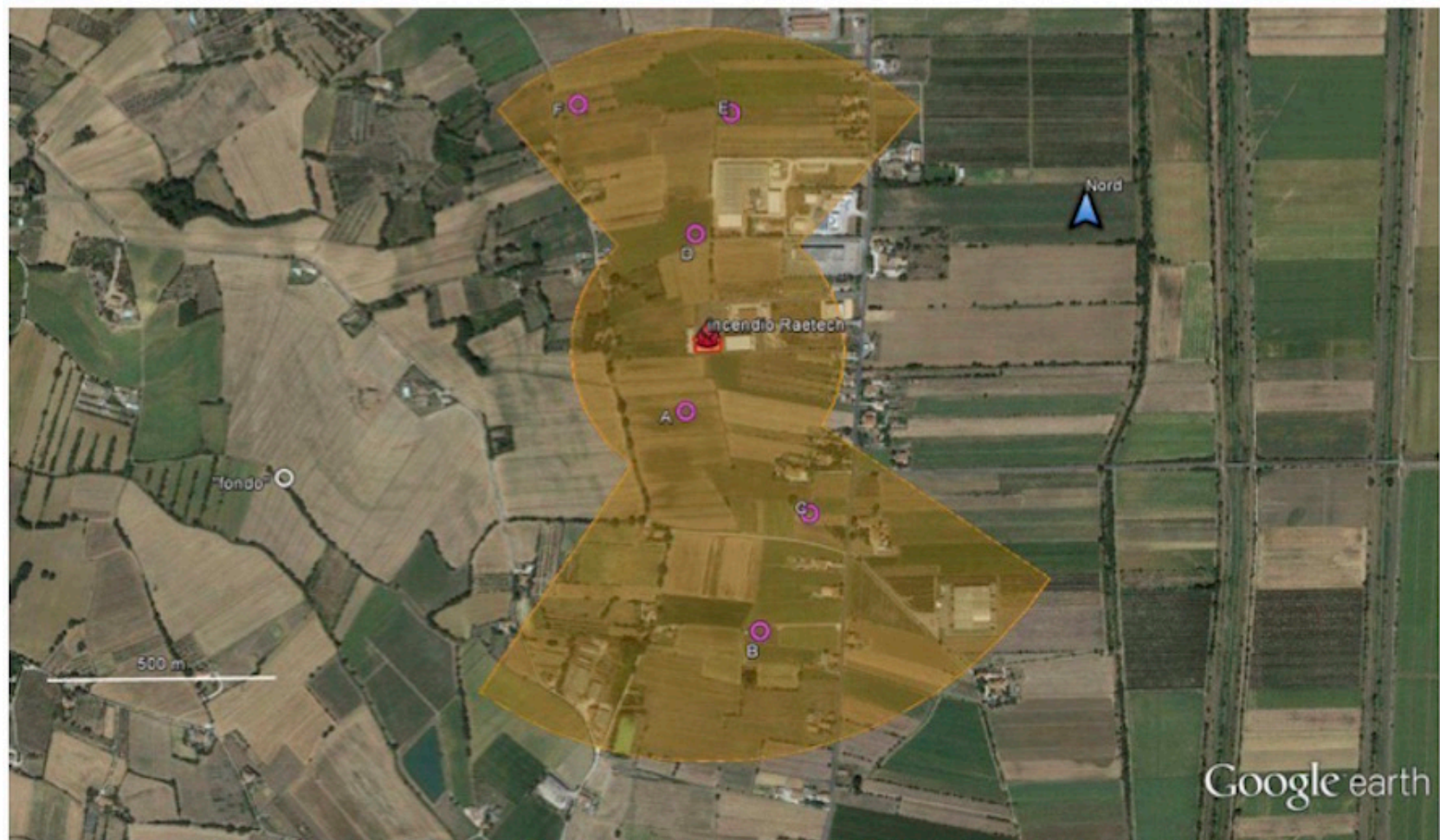
Figura 6: "zone di impatto" (Google Earth ©) potenzialmente interessata dalle sostanze sprigionate nel corso dell'incendio dello stabilimento Raetech (19 luglio 2016). Il simbolo rosso indica il punto in cui si è sviluppato l'incendio; le zone interessate sono indicate in arancione; i cerchi rosa indicano le posizioni orientative per gli eventuali prelievi di matrici ambientali (in bianco quello per l'eventuale "fondo").
